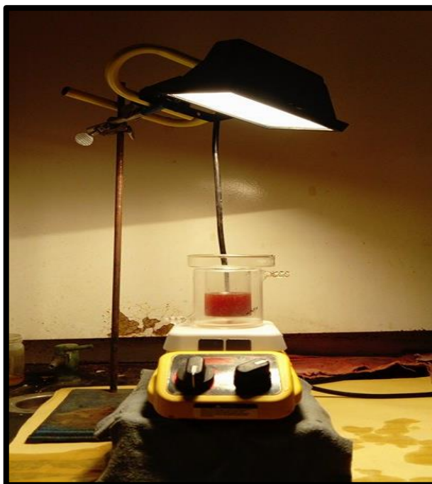
Figura 4.7 Montaje experimental para la oxidación del colorante Rojo Congo bajo luz visible.
