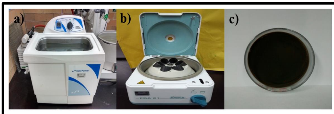
Figura 5.1 Proceso de purificación de nanopartículas ZnFe_2O_4 ; a) Sonicación; b) Centrifugado y c) Obtención de material seco.
