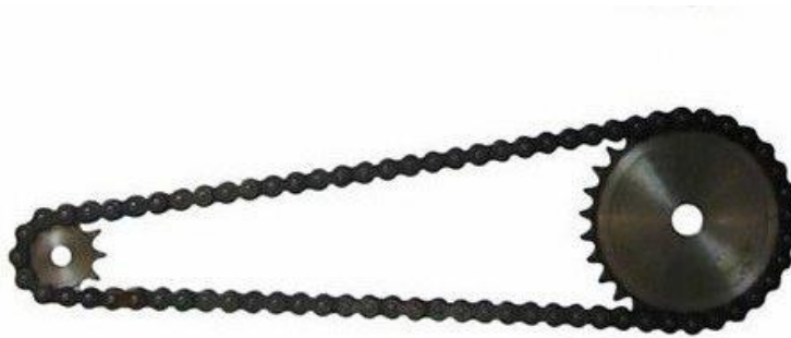
Ilustración 4.2-7 Cadena de transmisión. MecanESO 2005, recuperado de http://concurso.cnice.mec.es/cnice2006/material107/
