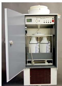
Ilustración 2.1-5 Colector utilizado en el estudio en la Amazonia. Recuperado de http://www.eigenbrodt.de
