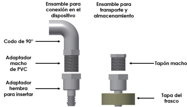
Ilustración 6.2-2 Diagrama de adaptación de la tapa del frasco. Elaboración propia.
