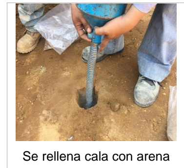
Diagrama 1 Proceso de elaboración de prueba de compactación en campo
