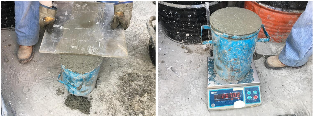
Figura 12 Determinación de la masa volumétrica del concreto en campo
