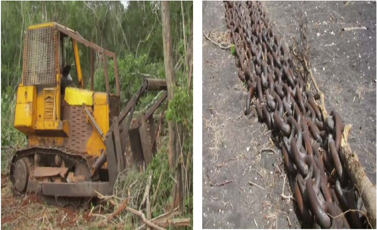
Fig. 26 Tractor y cadenas usados para aplanar terreno de siembra
