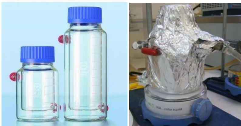
Figura 16. Reactor de doble pared cubierto con papel aluminio
