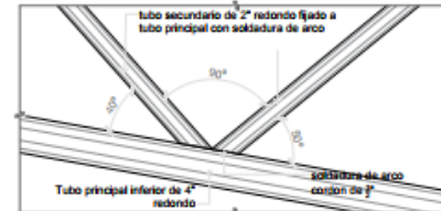
08 CONEXION CUERDA INFERIOR DETALLE
