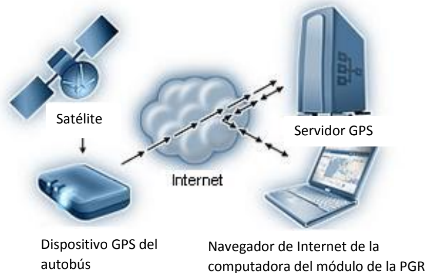
Ilustración 27 funcionamiento de sistema de monitoreo
