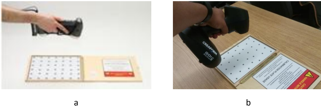
Figura 29. (a) Calibración de equipo de triangulación láser [27] y (b) calibración del equipo de luz estructurada.
