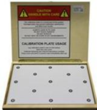
Figura 12. Tablas de calibración para escáneres 3D ópticos: (a) Handy Scan 700 [27], (b) GO! Scan 20 [28].
