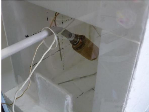
Figura. 56 Cámara criogénica con termopares tipo J y nitrógeno líquido
