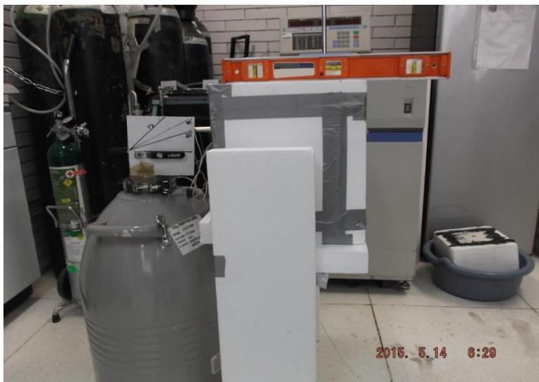
Figura. 16 Cámara criogénica con su base y calibrador
