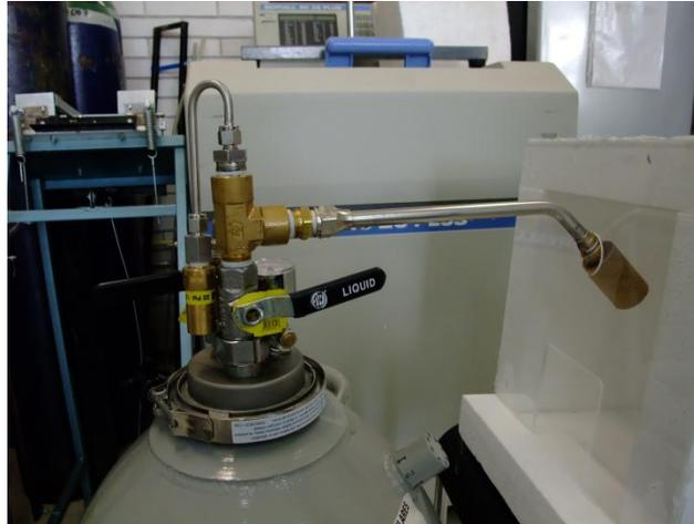
**Figura. 52 Separador de fases parte superior y válvula de venteo parte inferior**
