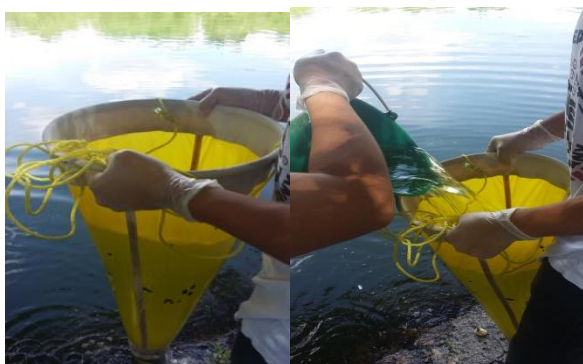
Figuras 3 y 4. Toma de muestra de Tezozómoc con una red de 20 \mu m de apertura de malla.
