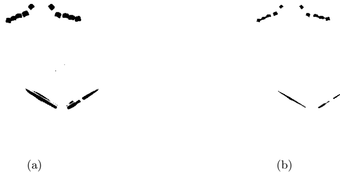
Figura 3.14: Filtrado de elementos pequeños: (a) imagen binaria con píxeles aislados y (b) erosión de componentes.
