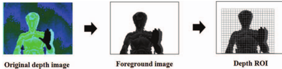
Figura 2.20: Proceso de obtención de la ROI de profundidad (Fuente: Usachokcharoen et al. [2015]).
