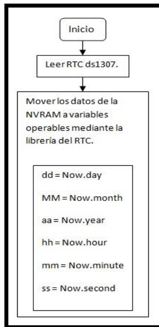
Figura 3.21. Diagrama de flujo de la carga de los datos del RTC. Fuente: Elaboración propia
