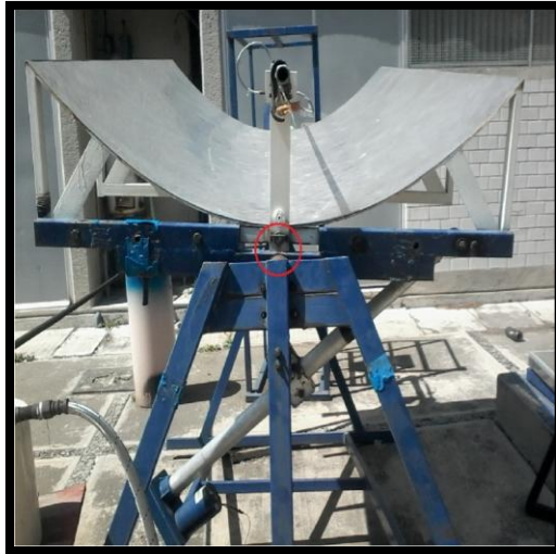
Figura 3.13. Eje de rotación del concentrador solar parabólico (círculo rojo). Fuente: Elaboración propia
