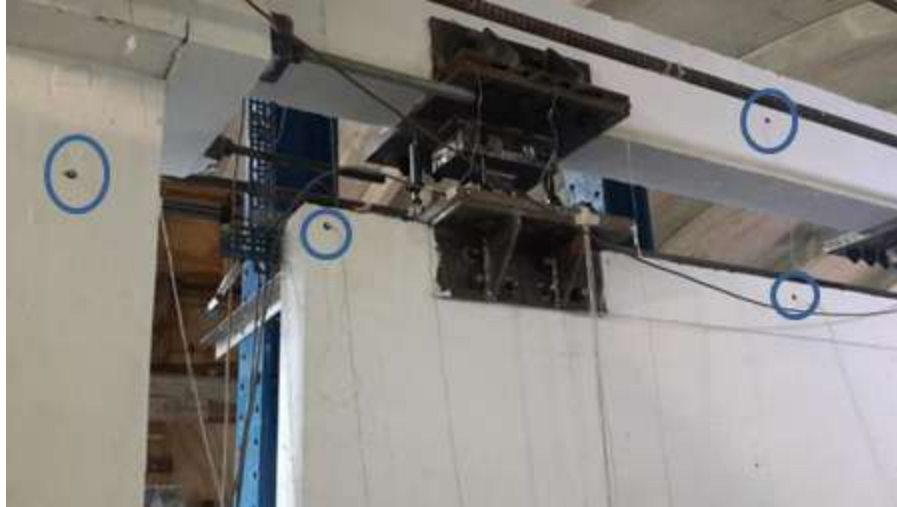
Fig. 2.14 Colocación de Leds sobre el modelo
