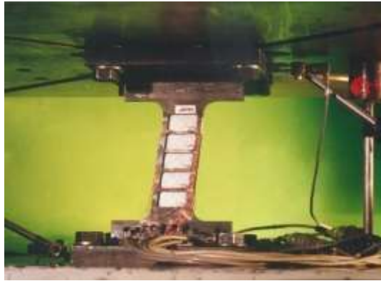
Fig. 1.6 Disipador de fluencia sometido a cargas laterales de corte [créditos: Luis Bozzo Estructuras y Proyectos S.L, 2017]
