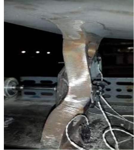
Fig. 2.22 Torsión en el alma del dissipador
