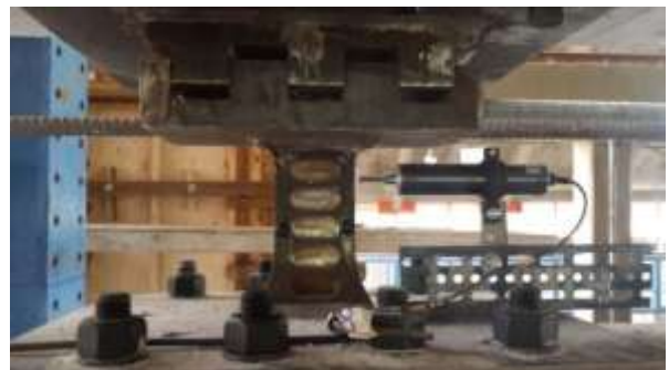
Fig. 2.9 Colocación de transductor 8
