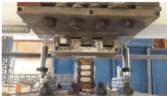
Fig. 2.10 Colocación de transductores 5 y 6
