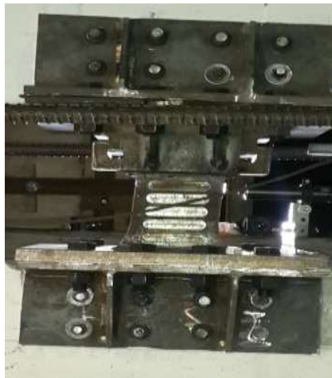
Fig. 2.28 Deformación lateral del disipador tipo 2
