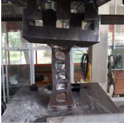
Fig. 2.21 Esfuerzo cortante en el alma del dissipador
