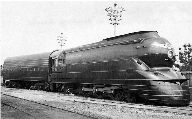
Fig. 8- El Famoso Torpedo de Dorwin Teague, uno de los mayores promotores del Streamlining , es una locomotora vieja forrada con una nueva piel de acero que no remite más a la tipología de las máquinas del Siglo XIX, al contrario, alude a la favorita relación moderna entre la velocidad y el progreso, aunque éstas sólo fueran gestos
