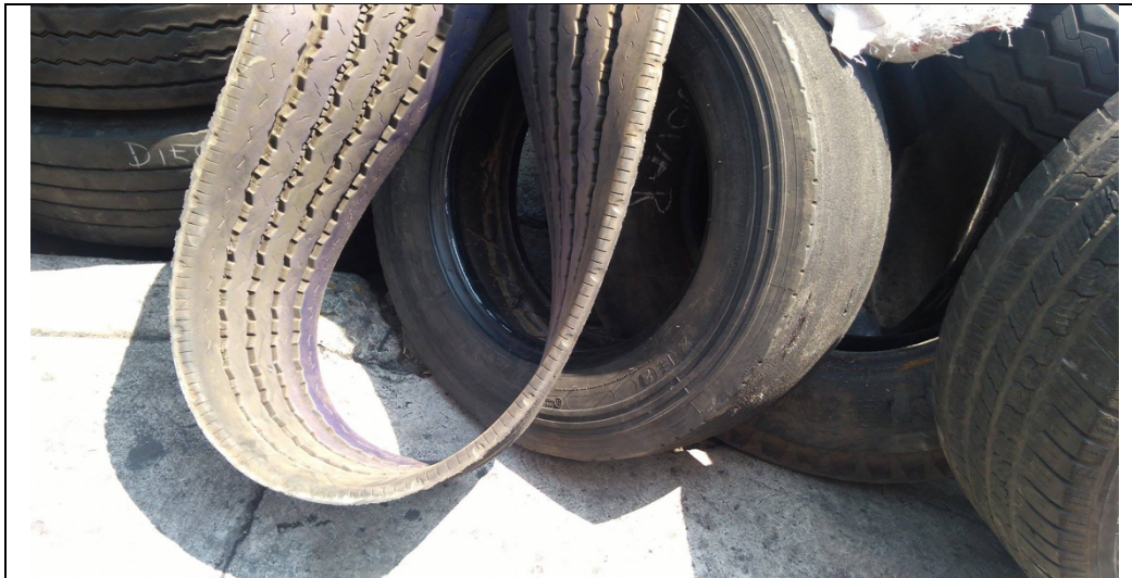
Figura 4.4. Separación de la banda de una llanta (Elaboración propia)
