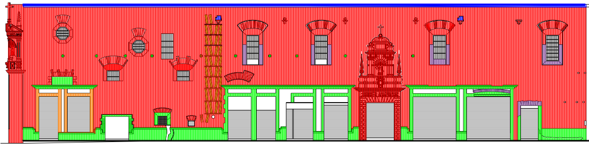
Ilustración 165. Estratificación de las fábricas históricas en la fachada oriente de lo que fuera el claustro principal del Convento de Jesús María.
