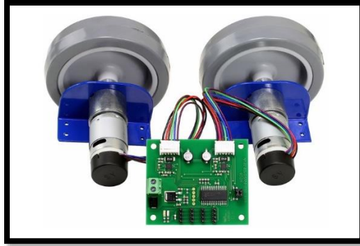
Figura 23.- Kit para la locomoción de la plataforma móvil, fuente: (RD02 - 12v robot drive, 2009)
