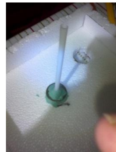
Figura 4.37 Fijando el motor agitador con PLASTI LOKA®
