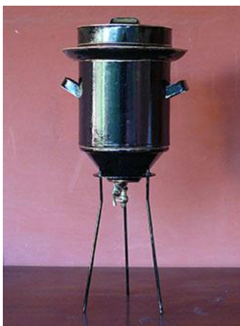
Figura 3.1 Calorímetro de hielo de Lavoisier y Laplace
