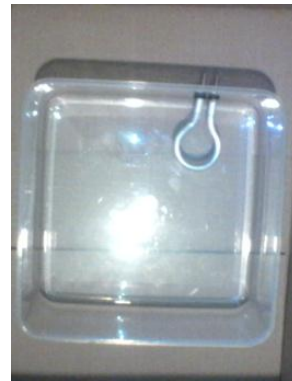
Figura 4.29 Resistencia eléctrica instalada
