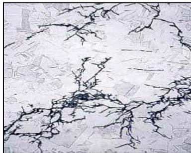
FIGURA 1-3. Aspecto de corrosión por esfuerzo.
