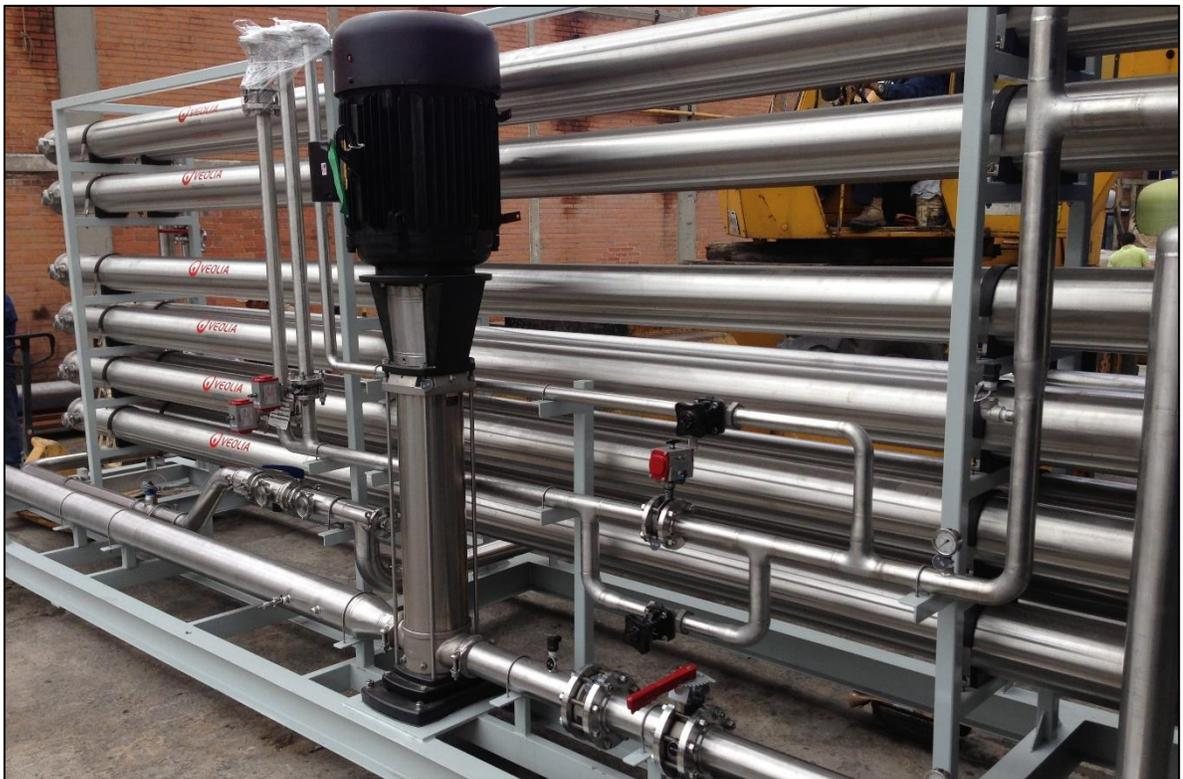
FIGURA 2-10. Diseño de una planta de sistema de ósmosis inversa sanitaria para una aplicación farmacéutica.
