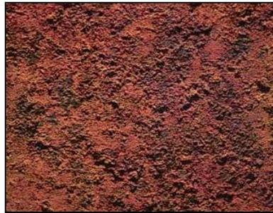
FIGURA 1-4. Superficie de acero con corrosión generalizada
