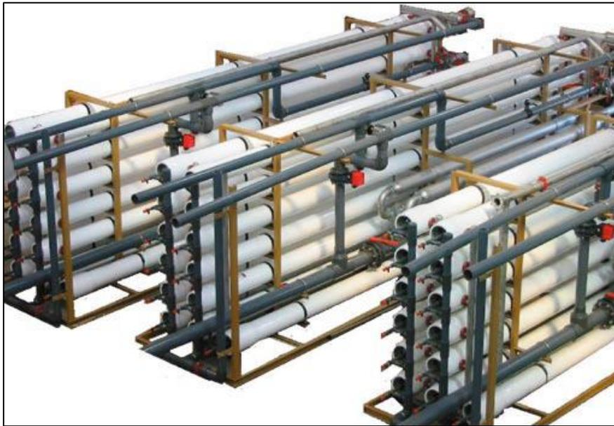
FIGURA 2-11. Aspecto de un conjunto de membranas para el tratamiento de agua por ósmosis inversa.
