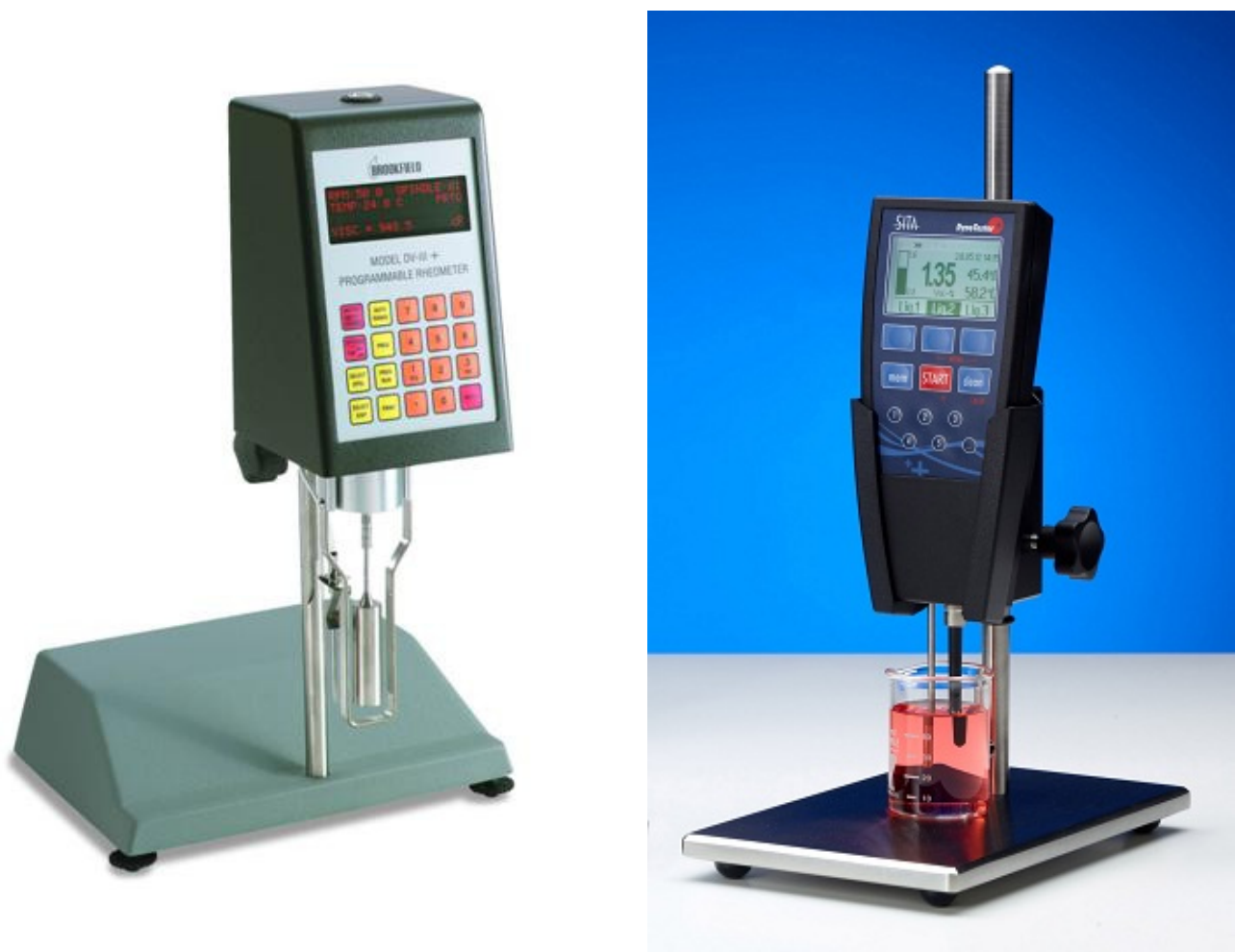
Figura 2.14: Reómetro Brookfield DV-III [44] y Tensiómetro SITA DynaTester+ [45]
