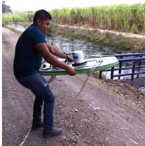
Figura 37 Realizando calibración del equipo M9 para compensar la interferencia magnética en las proximidades.
