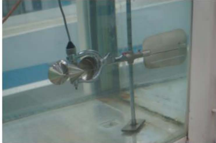
Figura 1 Molinete tipo Price sumergido en canal rectangular
