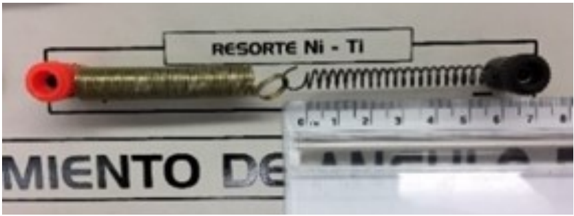
IMAGEN 23. PRUEBA 2. RESORTE CONVENCIONAL VS RESORTE AMF NiTi. COPYRIGHT ©
