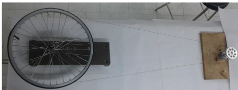
Figura 3.26 Sistema de impulsión usando MMF.
