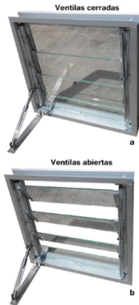
Figura 71.-Nueva propuesta de la ventana tipo persiana, en el cual se ha utilizado el accionador solar, como mecanismo acciona de cierre y apertura. a) Las ventilas, se muestran cerradas cuando la temperatura del accionador es superior a la del ambiente. b) Las ventilas se muestran abiertas, estado que mantiene cuando la temperatura del resorte es inferior por arriba de los 40°C, al ser calentado por el sol.
