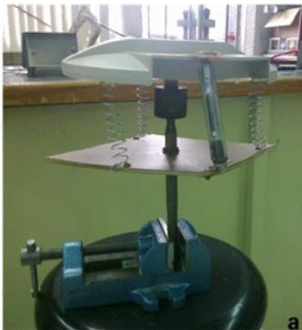
Figura 71.-a) Fotografía del modelo físico desarrollado, utilizando piezas de refugio. b) Este esquema, es un modelo virtual creado en el Programa de modelado Inventor, como propuesta del prototipo final. De este modelo se generan los planos a detalle, con el cual serán fabricadas cada una de las piezas.
