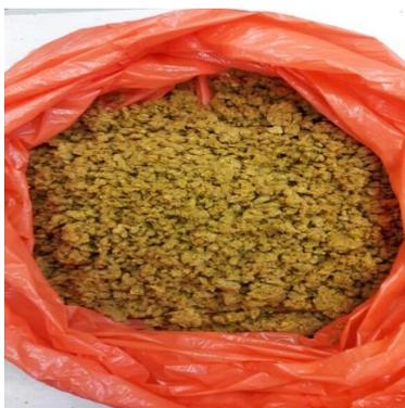
***Figura 7. Aspecto de la materia prima, cáscara de toronja (albedo y flabelo) libre de aceites, a la salida del reactor termo-mecano-químico.***
