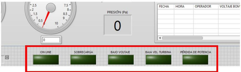
Fig. 3.38 Ubicación de los indicadores de alarmas en el panel frontal.
