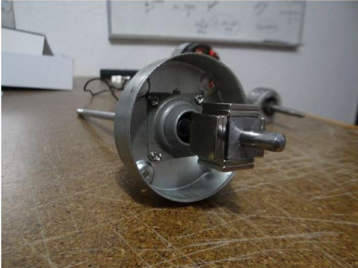
*Fig. 4.6 Vista del eje del alternador con el rotor reconstruido.*
