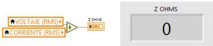
*Fig. 5.32 Obtención de impedancia e indicador en panel frontal.*
