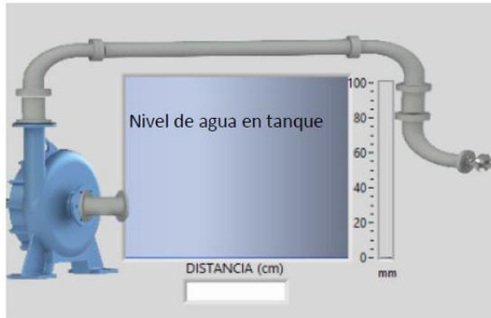
Fig. 5.5 Indicador de nivel en panel frontal.
