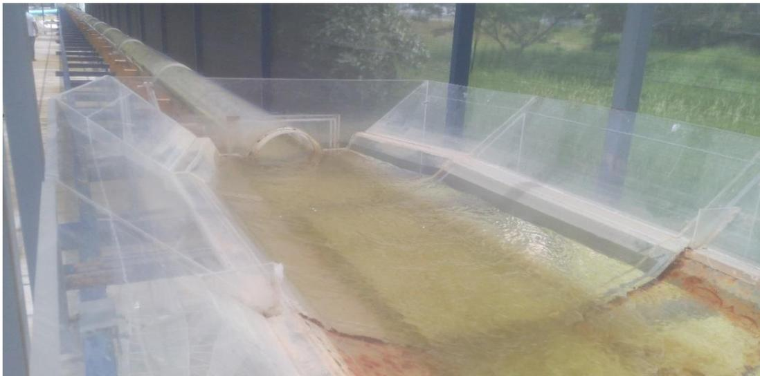
Figura 26. Vista del túnel aguas abajo con un gasto de 16.68 l/s equivalente en prototipo a 104.36 m<sup>3</sup>/s
