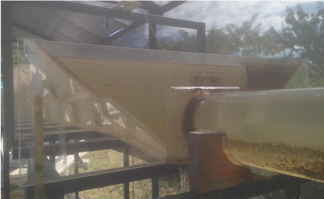
Figura 34. Profundidad a la salida del túnel = 30.00 cm
