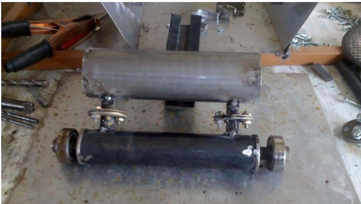
Figura 21. Unión de eje central con contrapeso central
