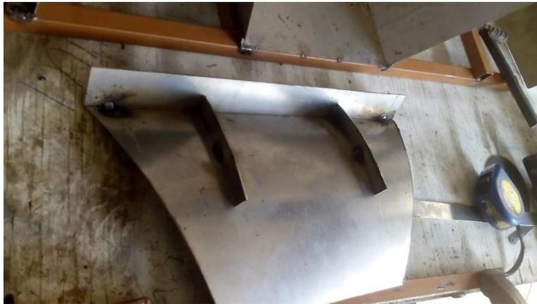
Figura 17. Soportes para flotador frontal de la compuerta AMIL
