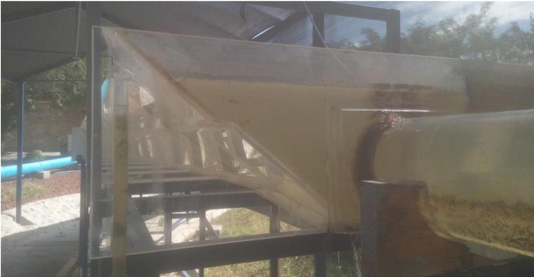
Figura 25. Carga aguas arriba del túnel de 8.70 cm, presurización con gasto de 16.68 l/s equivalente en prototipo a 104.36 m<sup>3</sup>/s
