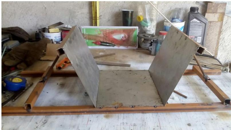
Figura 15 Placas de solera para compuerta AMIL
