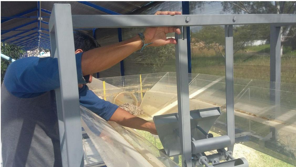
Figura 40. Colocación de compuerta en modelo físico
