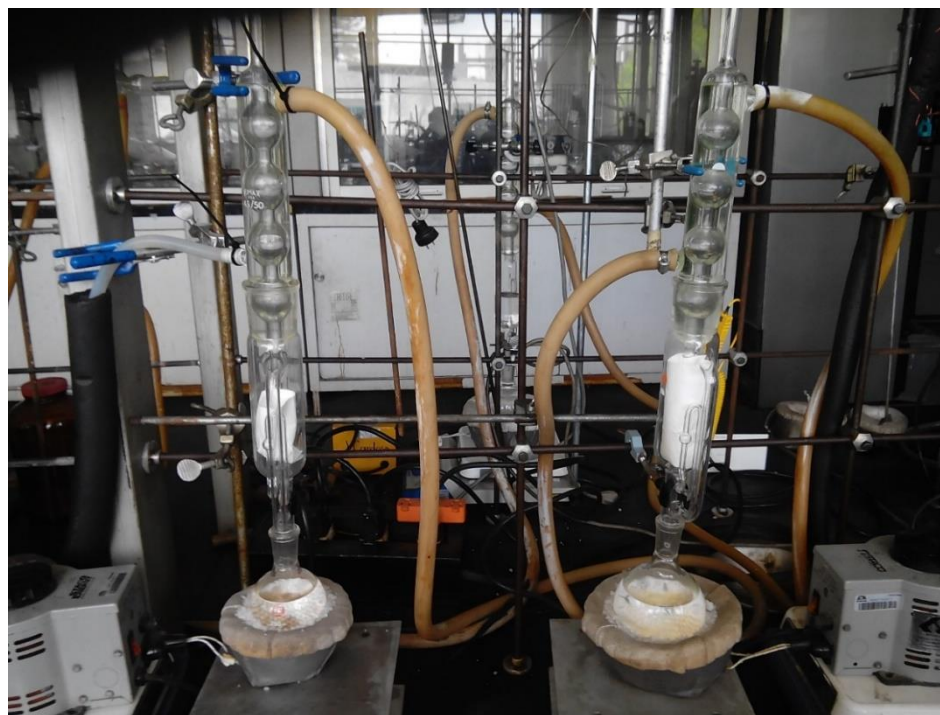
Figura 3.2.8 Lavado de la resina en el equipo Soxhlet.
