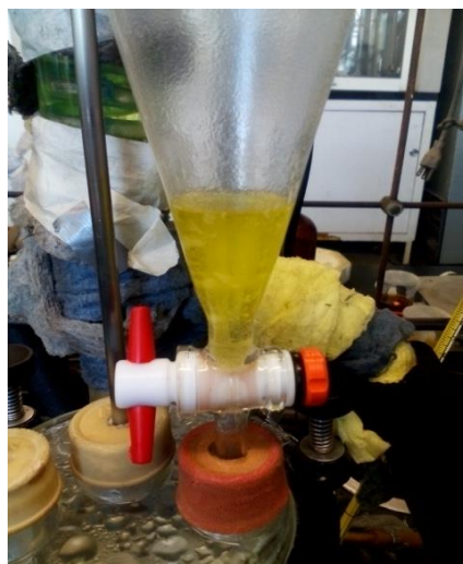
Figura 3.2.2 Mezcla de monómeros e iniciador.
