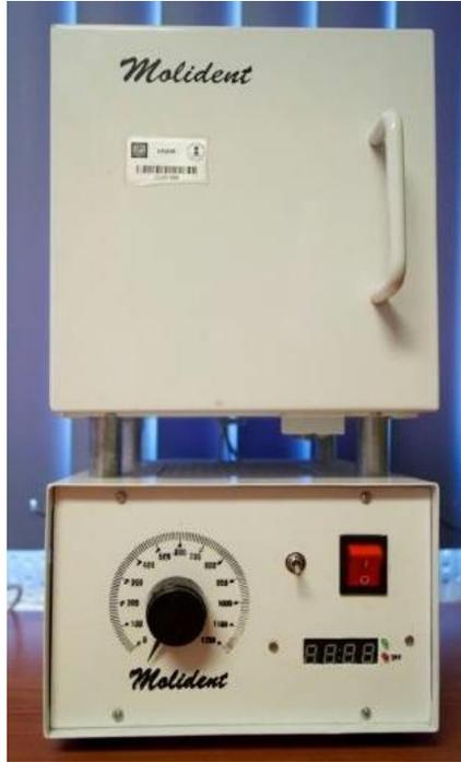
Figura 6. Horno para descencerado Molident. Fuente Directa
