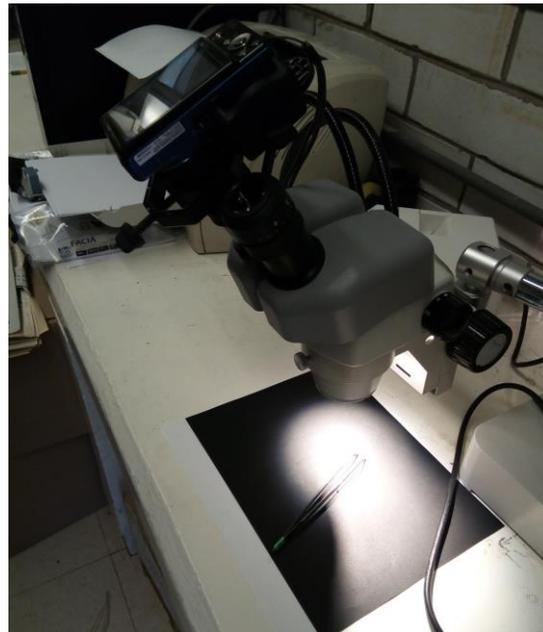
**Figura 9. Cámara OLYMPUS colocada en el adaptador fotográfico. Fuente Directa**
