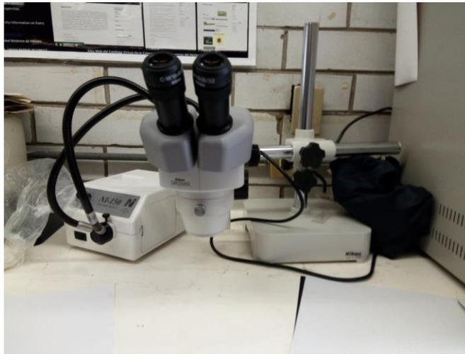
**Figura 8. Microscopio estereoscópico. Fuente Directa.**
