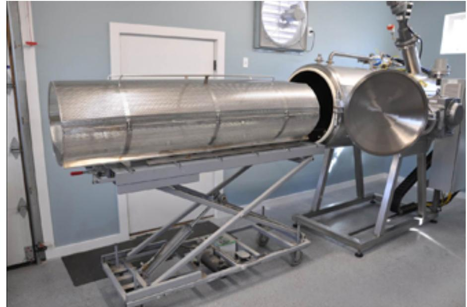
*Imagen, Estación de hidrólisis alcalina, método de descomposición química acelerada, al termino del proceso, se dispone de restos óseos y prótesis .*
