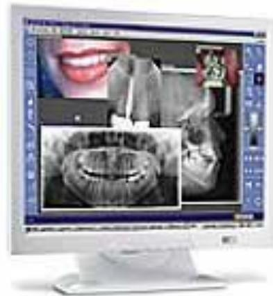
La *radiovisiografía* se caracteriza por ser un sistema de diagnóstico mediante imágenes que utiliza un sensor especial en lugar de la película convencional sensible a los rayos X. El sistema consta de los siguientes elementos:
