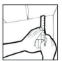
1. Escala la altura del alfiler: usando el nivel (L1) se establece nivel de su extremo que se usará como referencia de nivel para el diseño de cualquier elemento que se instale en la tubería. Marque la altura deseada en cada esquina de la habitación.
