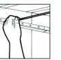
6. Instalación de las tuberías secundarias: Coloque un tubo de plástico en ángulo recto (90°) y bórrela a mano. Marque la altura deseada en cada esquina de la habitación.
