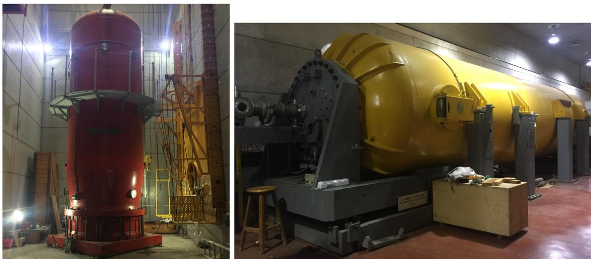
Figura 4.1: Izquierda: Acelerador Van de Graaff de 5.5 MV del Instituto de Física de la UNAM. Derecha: Acelerador Tandem Van de Graaff de 6 MV del ININ, México.
