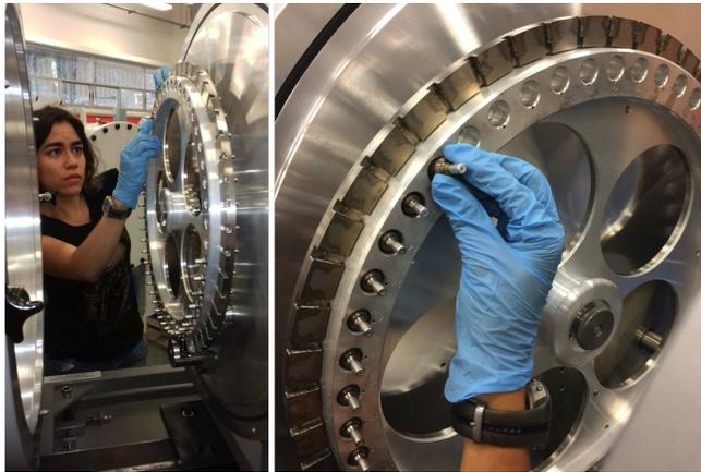
Figura 4.9: Carrusel donde se colocan las muestras a analizar por AMS.
