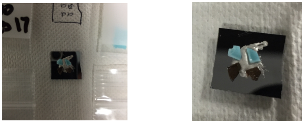
Figura 4.8. Preparación de muestras con recubrimiento de osmio para SEM y EDS (RIKEN)
