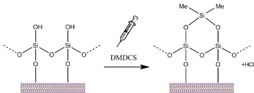
Figura 4.3. Preparación de moldes con DMDCS. Modificación para la desactivación superficial
