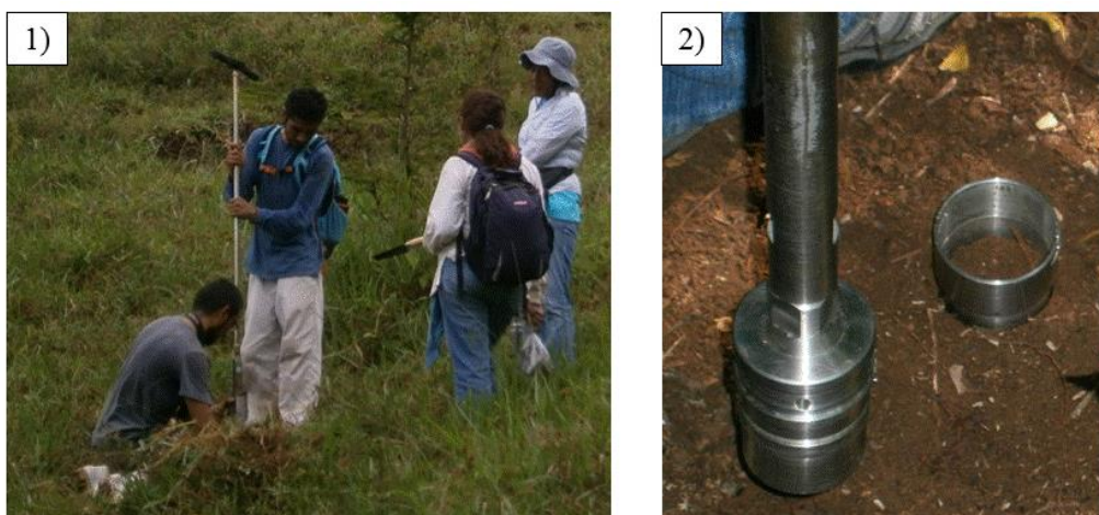
Figura 5.4. 1) señala cómo se tomaron las muestras en cada sitio para determinar los valores de respiración microbiana edáfica y las variables edáficas. 2) muestra el nucleador de densidad aparente.
