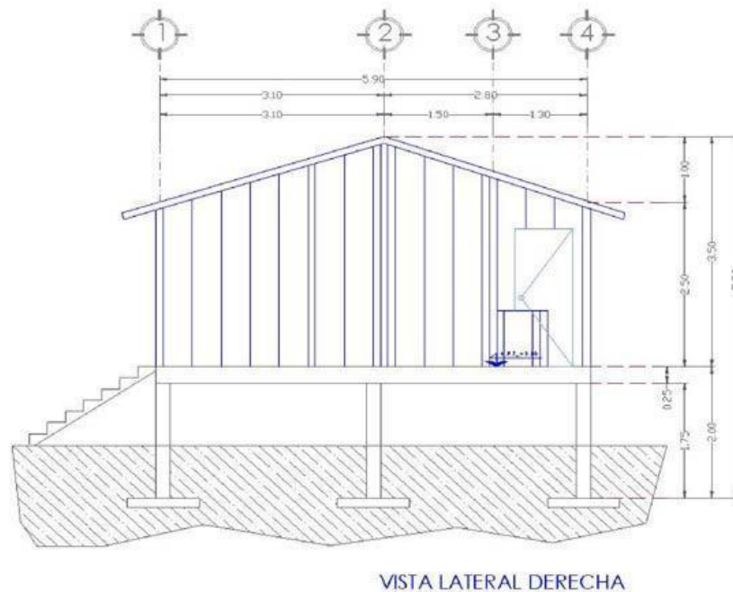
FIGURA 15.- Vista Lateral Derecha Conjuntos de Casa Habitación (palafitos).
