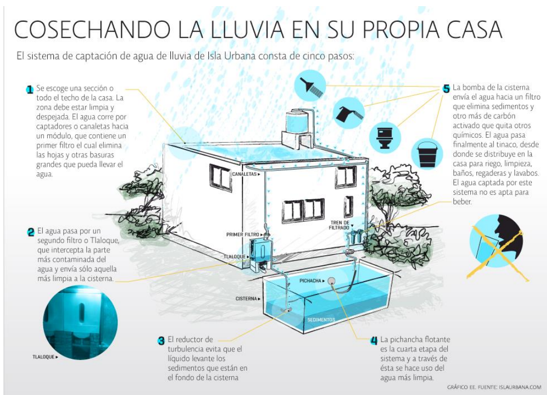
FIGURA 26.- Esquema Captación de Agua en una Vivienda.
