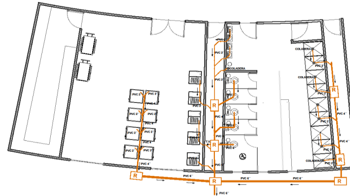
PLANTA ARQUITECTONICA- SANITARIO 3 INSTALACION SANITARIA
