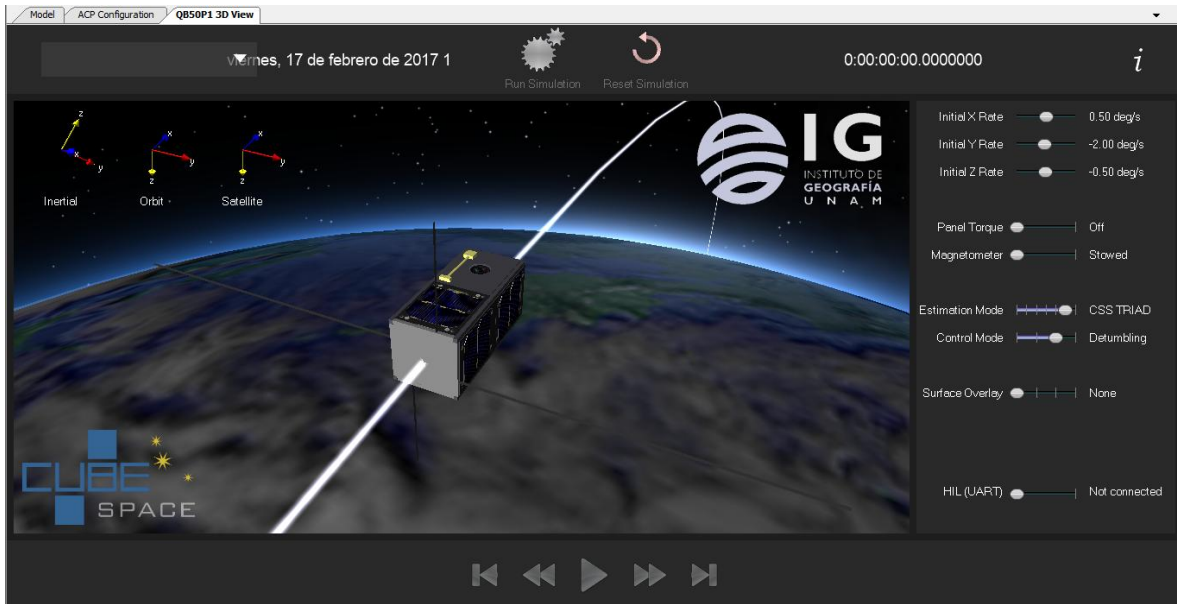
Figura 6.9 Interfaz del programa EOSim HIL, indicando el tipo de sistema utilizado para realizar pruebas con el fin de detectar la orientación.
