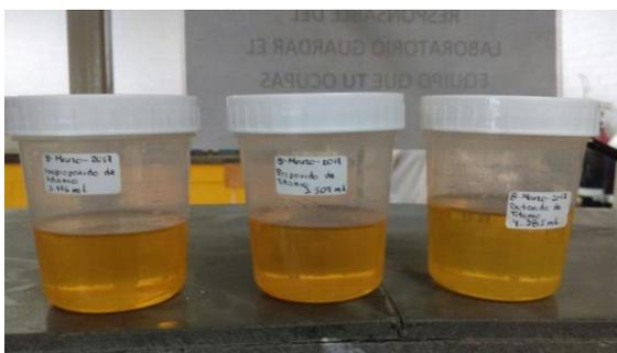
Figura N° 23 Matriz híbrida de  $\text{SiO}_2$  con los precursores de  $\text{TiO}_2$
