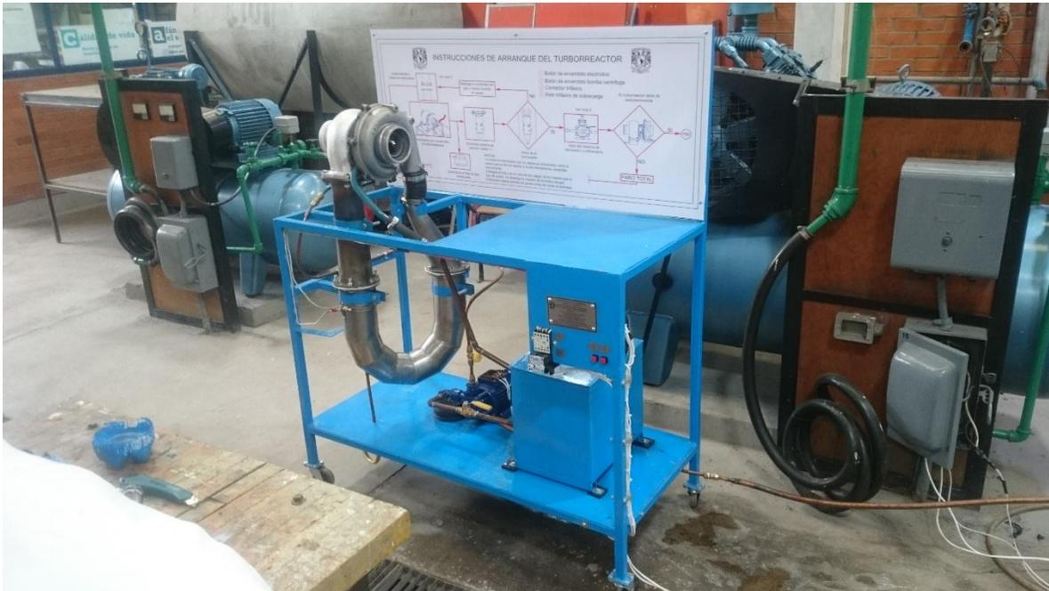
Imagen 9.45 Ensamble final del Turborreactor.
