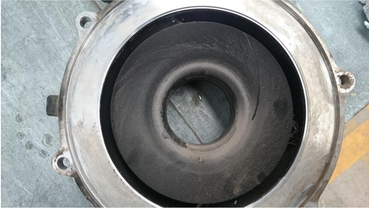
Imagen 9.3 Tapa del turbocompresor, se observan (remarcada con plumón) la trayectoria absoluta de las partículas.
