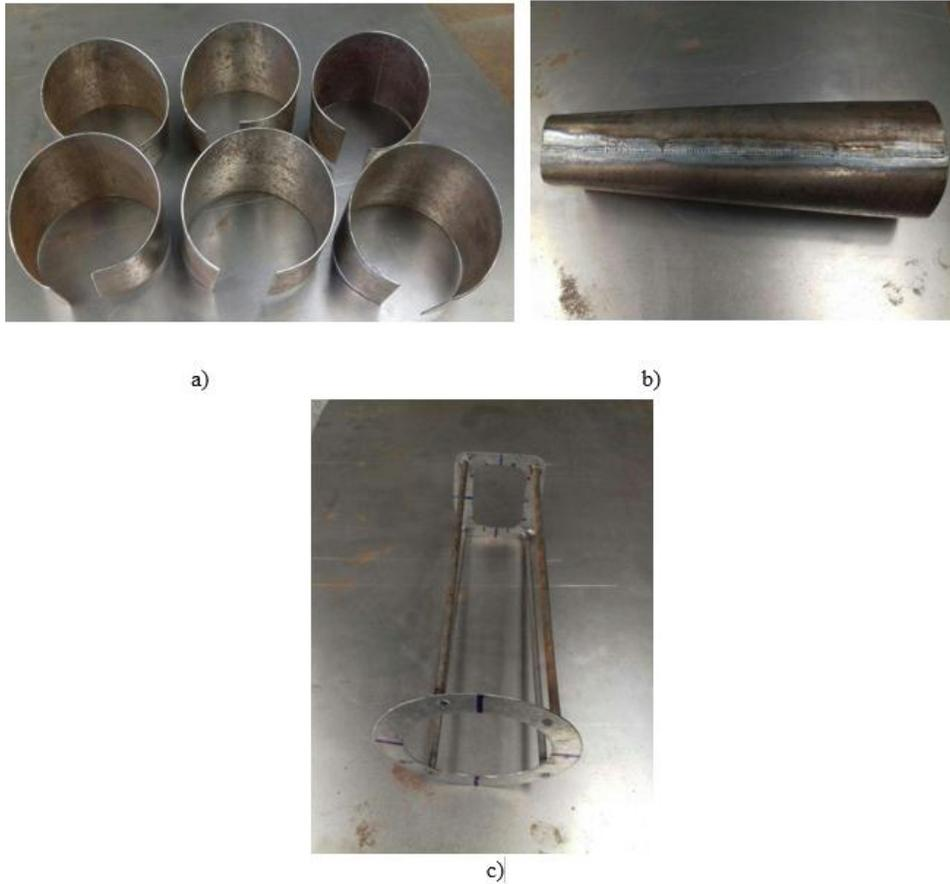
Imagen 9.24 a) Piezas inferiores cortadas del tubo de interconexión, b) ducto soldado de conexión de la turbina de gas, c) molde utilizado para soldar del tubo de interconexión de la turbina de gas (b).
