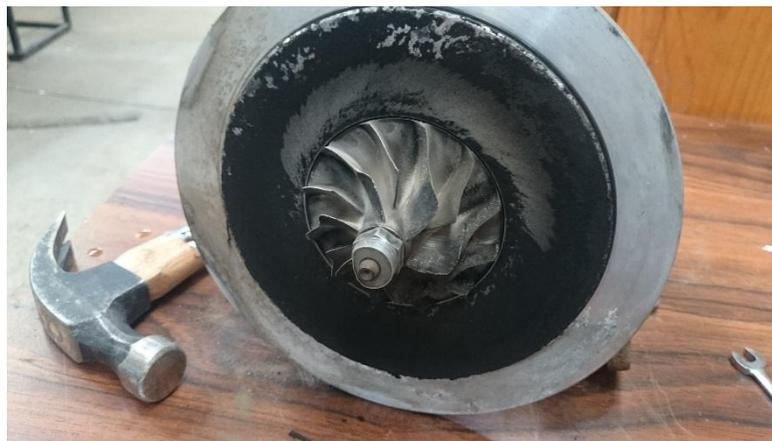
Imagen 9.1 Rodete del turbocompresor montado en la base.
