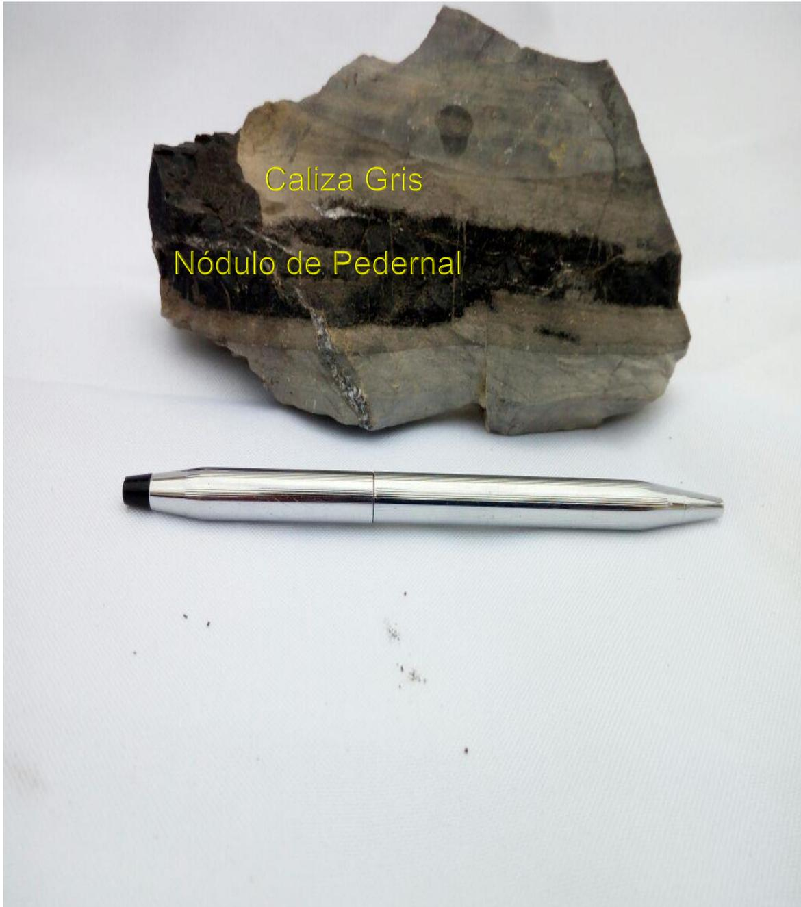
**FIG. 16 Muestra 1: Roca Caliza arcillosa grisácea con presencia de nódulos de pedernal oscuro.**
