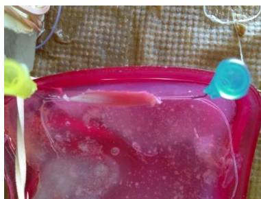
Figura 15. Representación del músculo aislado y sujetado dentro del recipiente con base de silicón y sumergidos en Krebs.
