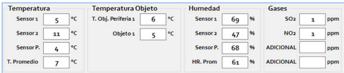
Fig.4.5 Área de sensores, prueba de lectura de sensores
