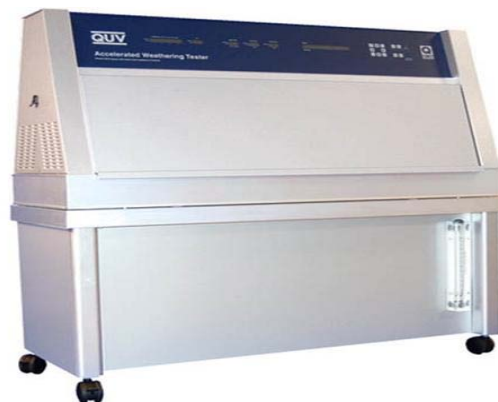
Fig.3.4 Equipo QUV de la Empresa Q-Lab para ensayos de envejecimiento acelerado
