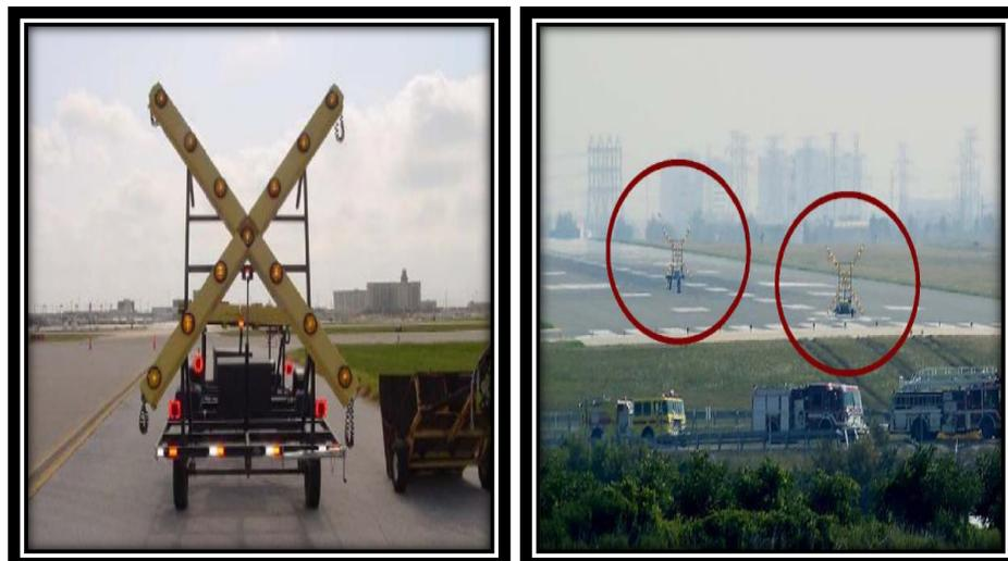
Imagen 20 Ejemplos de paneles de señales
