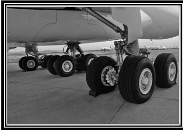
Imagen 6 Configuración de tren de aterrizaje del Airbus 340
