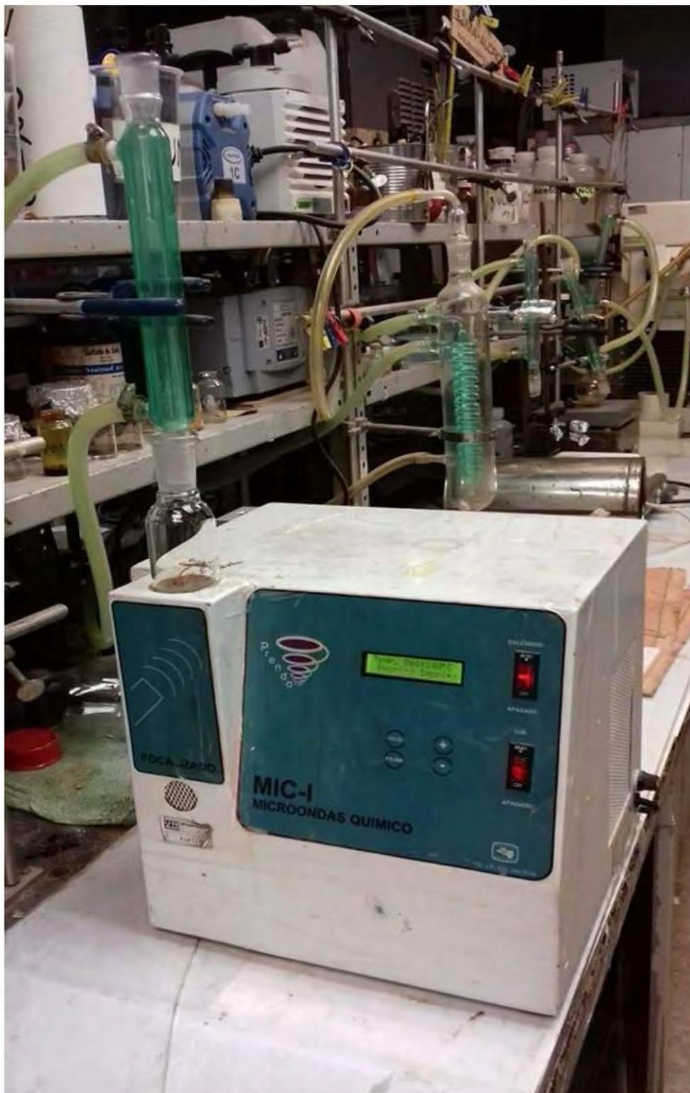
Figura 22. Equipo de microondas monomodo.
