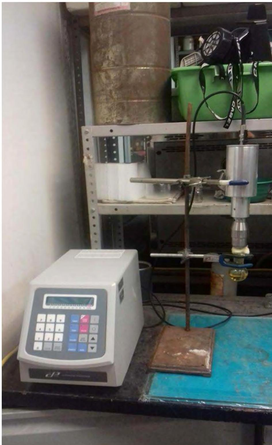
**Figura 23.** Equipo de ultrasonido de sonda.
