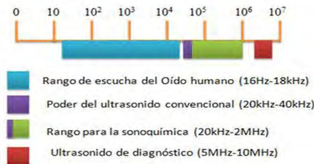
**Figura 12.** Rangos de frecuencia de ultrasonido.
