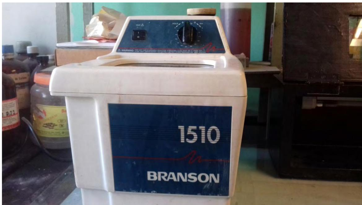
**Figura 24.** Equipo de ultrasonido de baño.
