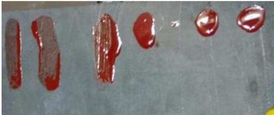
**Figura 23 Muestras para determinar tiempo de secado en minutos**
