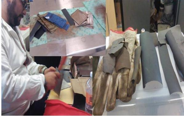
**Figura 10 Método SSPC-SP 2**
