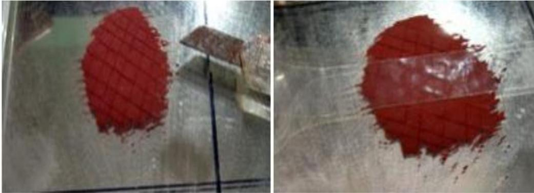
**Figura 22 Corte y adherencia de las muestras**
