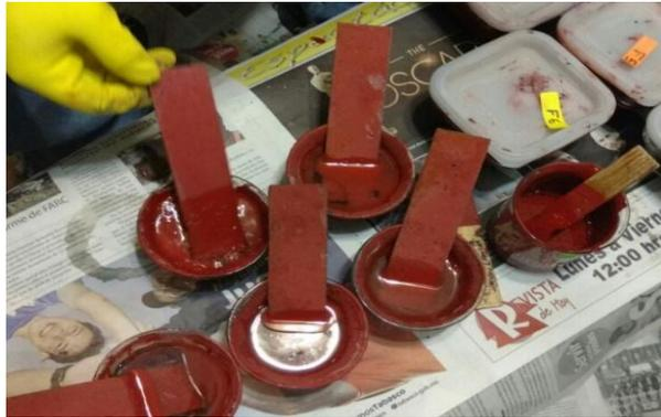
**Figura 20 Prueba de tixotropía aplicada a las formulaciones**
