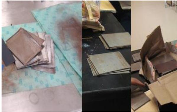
**Figura 9 Preparación de las placas de acero al carbón (150mm x 100 mm x0.989mm)**
