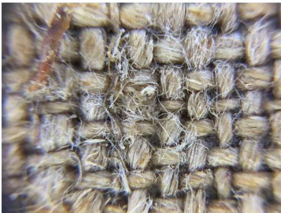
Figura 23. Fotomicrografía del lienzo del cuadro de Vallejo, se observa el tejido en tafetán con hilos irregulares, lo que comprueba su origen preindustrial.
