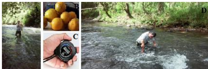
Figura 5. Muestreo comunitario del flujo del río en el sitio Seis de enero. A. Flotador atrapado con una red, después de ser lanzado. B. Tipo de flotador utilizado (naranja). C. Cronómetro. D. Medición de la sección transversal del río.
