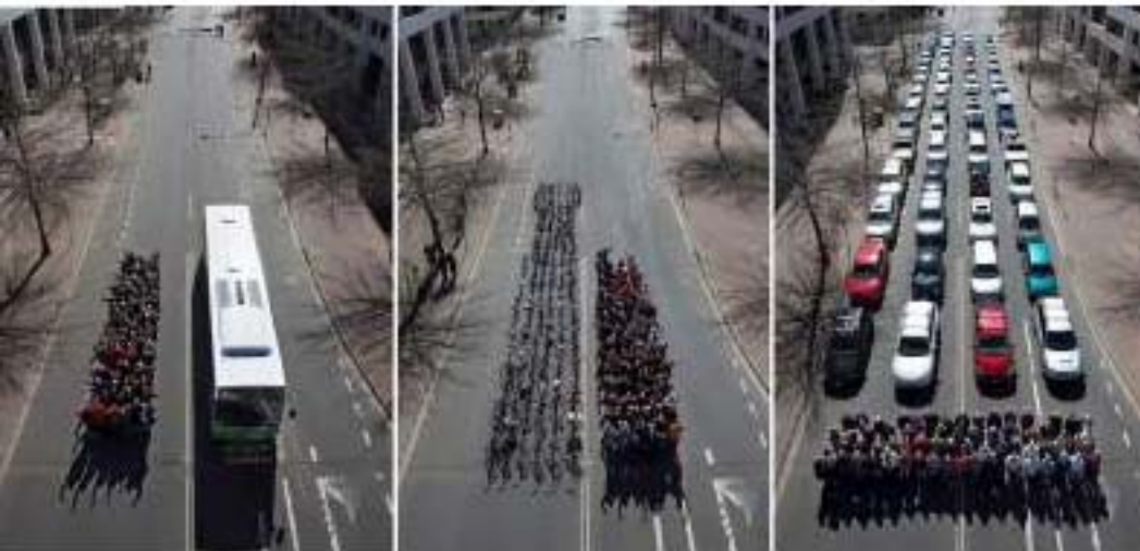
Estudio comparativo entre un autobús, bicicletas y automóviles con el mismo número de personas. Imagen producida por Cycling Promotion Fund.
