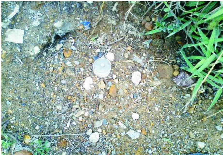
Foto 1. Banco de nivel instalado para levantamiento topográfico
