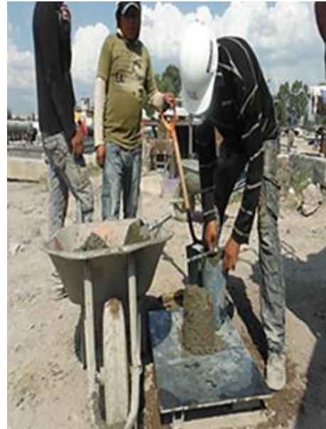
FOTOGRAFIA 47: PRUEBA DE REVENIMIENTO.
