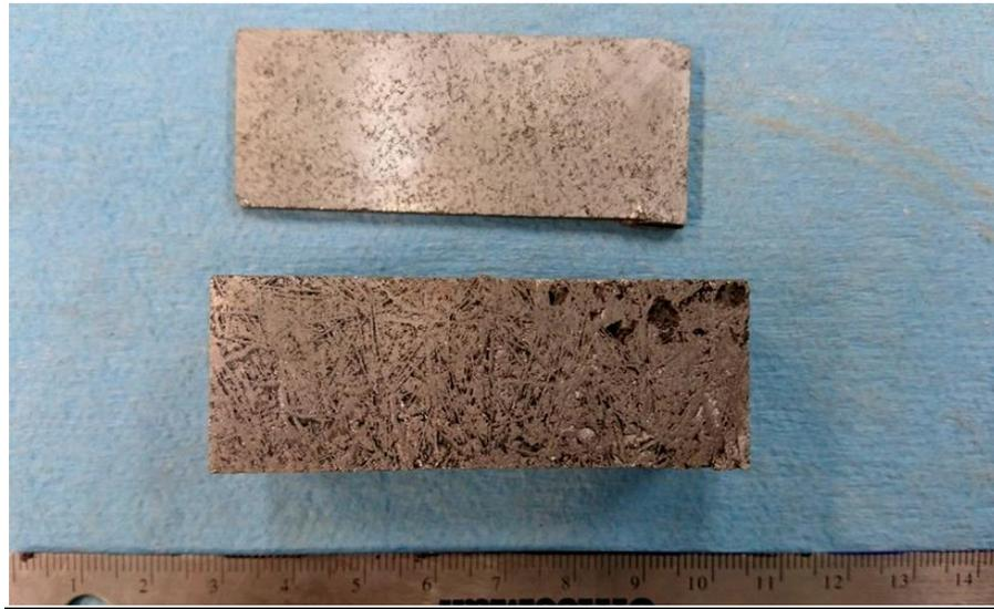
*Figura 2.4 Sección de la aleación Al<sub>62</sub>Cu<sub>28</sub>Fe<sub>10</sub>*
