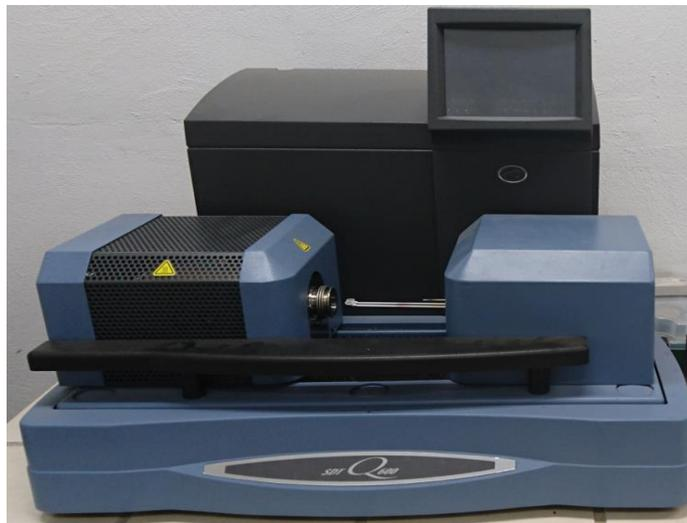
*Figura 2.8 Fotografía del equipo calorímetro diferencial*
