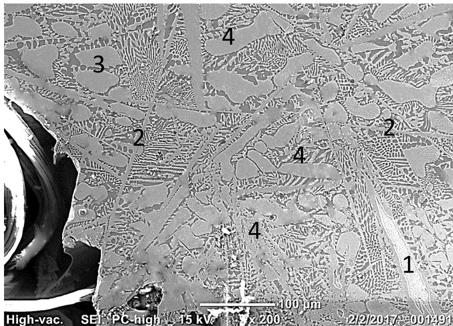
*Figura 3.23 Micrografías para la aleación Al<sub>79</sub>Cu<sub>15</sub>Fe<sub>6</sub> con tratamiento térmico a 850°C durante 6 h*
