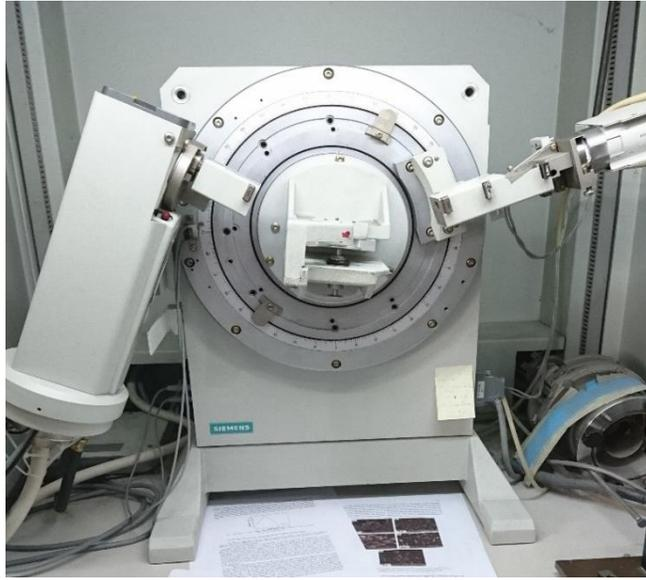
*Figura 2.6 Fotografía del equipo de difracción de Rayos X*
