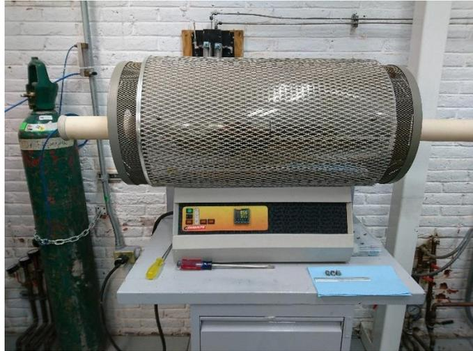
*Figura 2.9 Fotografía de la mufla cilíndrica para tratamiento térmico*
