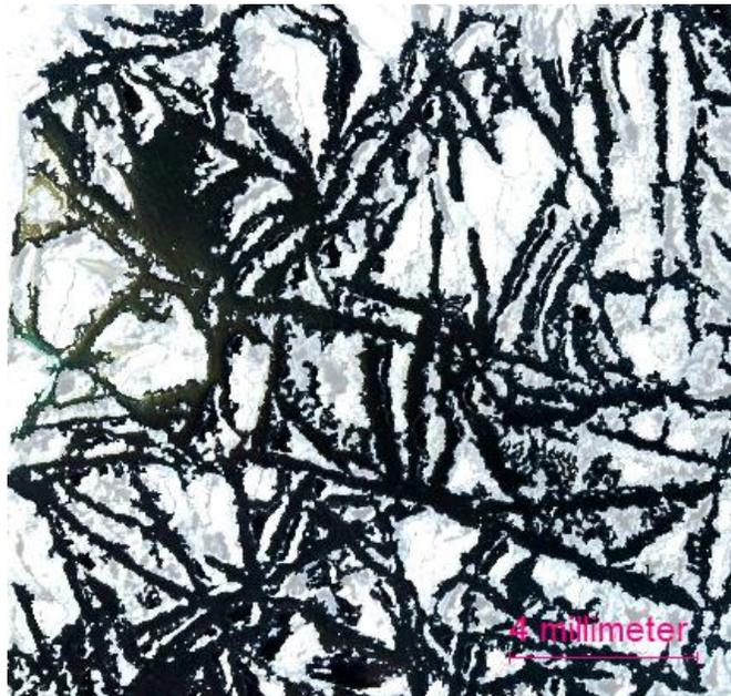
*Figura 3.33 Imagen tratada con el software Photoshop para la obtención de la porosidad*
