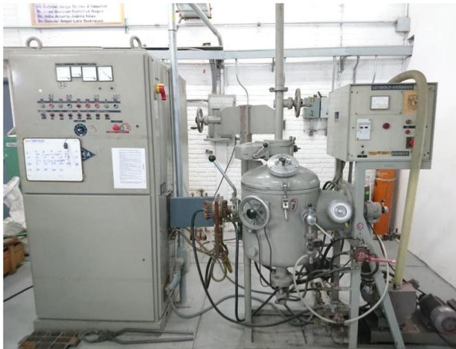
*Figura 2.2 Fotografía del horno de inducción*
