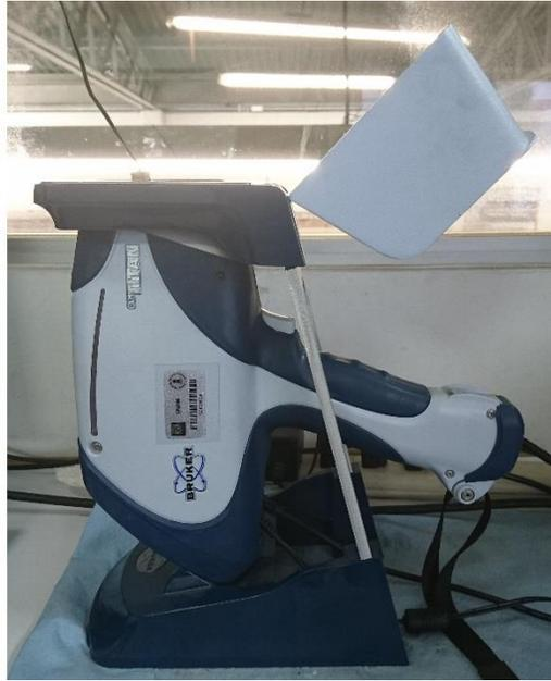
*Figura 2.5 Fotografía del equipo de fluorescencia de Rayos X*
