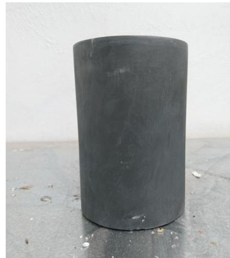
*Figura 2.3 Crisol de grafito, sin recubrimiento*
