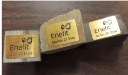
**Figura 1.3:** Muestras de shale de diferentes orígenes, de izquierda a derecha: Shale de Utah, Shale de Estonia, Shale de Jordania.
